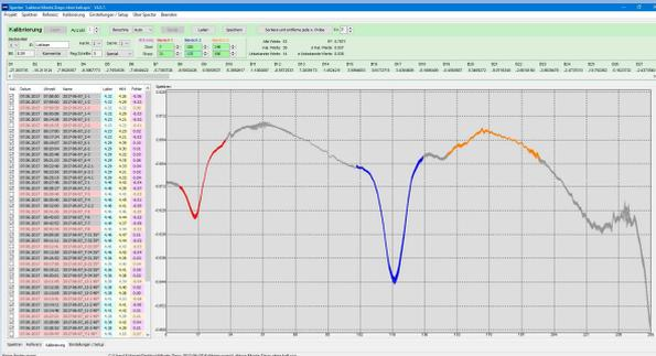
Die Probe wird mit einer speziell entwickelten Halogenlampe bestrahlt. Die dadurch entstehende diffuse Reflexion (diese enthält die nötigen Informationen über die Bestandteile) wird über ein Glasfaserkabel zum Spektrometer übertragen. Hier wird das gemessene Spektrum in 255 Stützpunkte geteilt.
